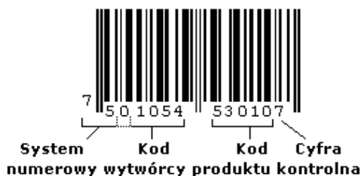
Rys.1. Struktura numeru w kodzie EAN-13
