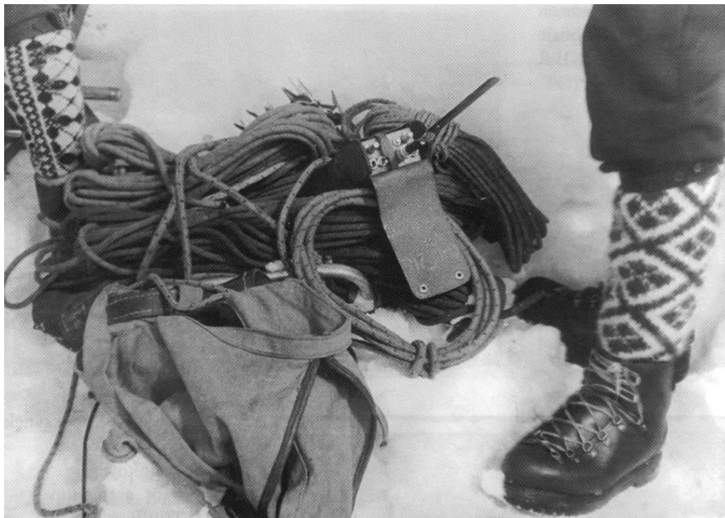
Fotografia 3. Sprzęt z lat 60. i 70. – szelki Grammingera i radiotelefon Klimek Źródło: archiwum TOPR
